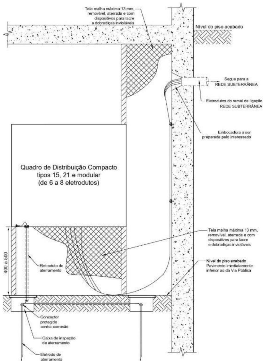
**Figura 14 -** Quadro de Distribuição Compacto instalado ao nível imediatamente inferior de 6 a 8 eletrodutos com cubículo de cabos - Rede subterrânea
