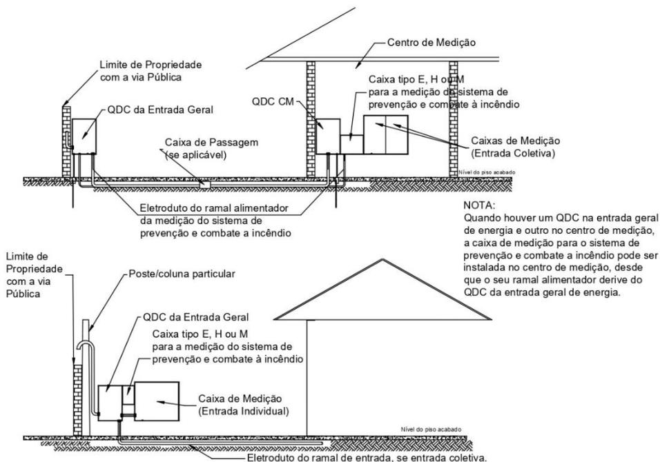
**Figura 15 - Conexão de medição para o sistema de prevenção e combate à incêndio em QDC**
