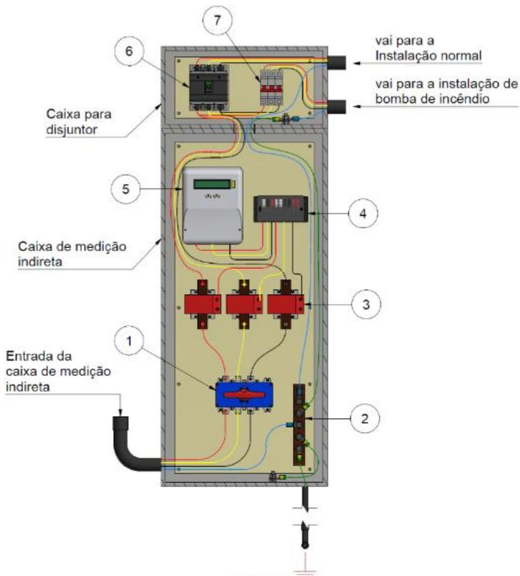
**Detalhe 3****b) Esquema de ligação de instalação com bomba de incêndio**
