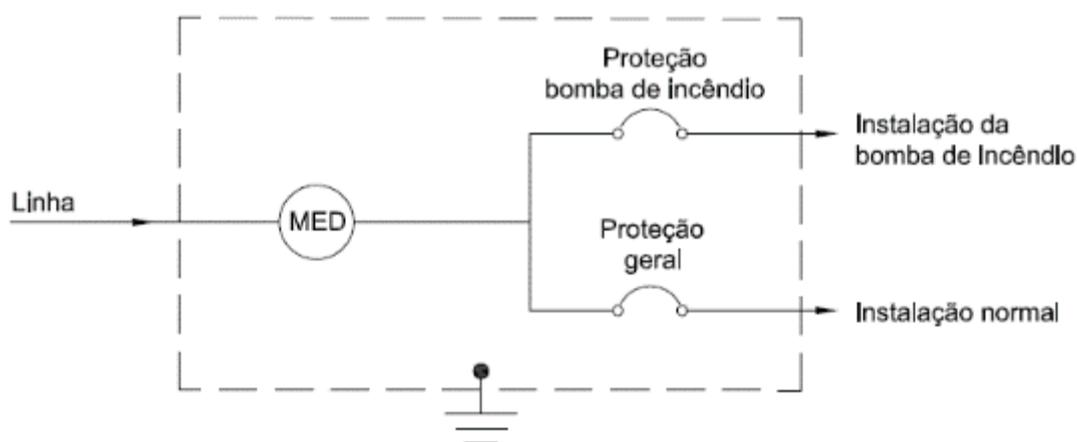
Figura 1 - Conexão da Bomba de Incêndio – Medição Direta
