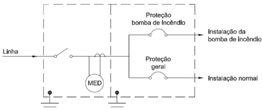
Figura 2 - Conexão da Bomba de Incêndio - Medição Indireta
