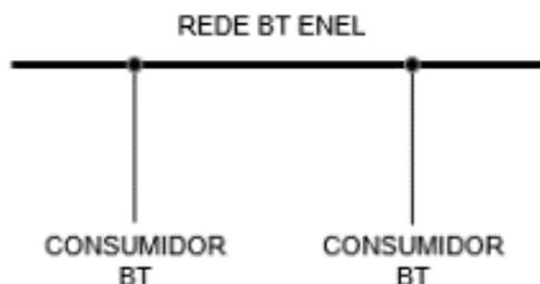
**Figura 3 - Conexão de cliente BT - Rede Aérea**
