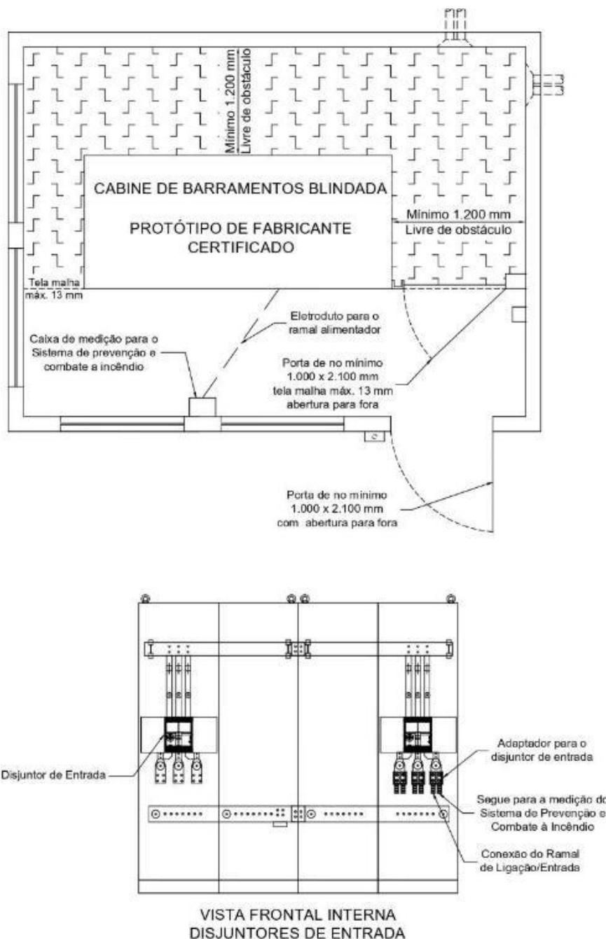
**Figura 21** - Ligação de medição para o sistema de prevenção e combate à incêndio em cabine de barramentos
