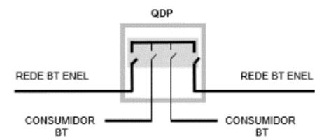
**Figura 4 - Conexão de cliente BT - Rede Subterrânea**
