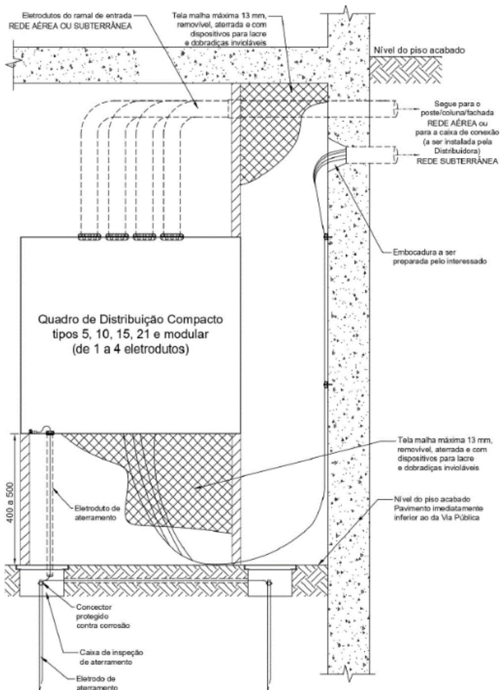
**Figura 12 -** Quadro de Distribuição Compacto instalado ao nível imediatamente inferior de 1 a 4 eletrodutos com cubículo de cabos - Rede aérea ou subterrânea
