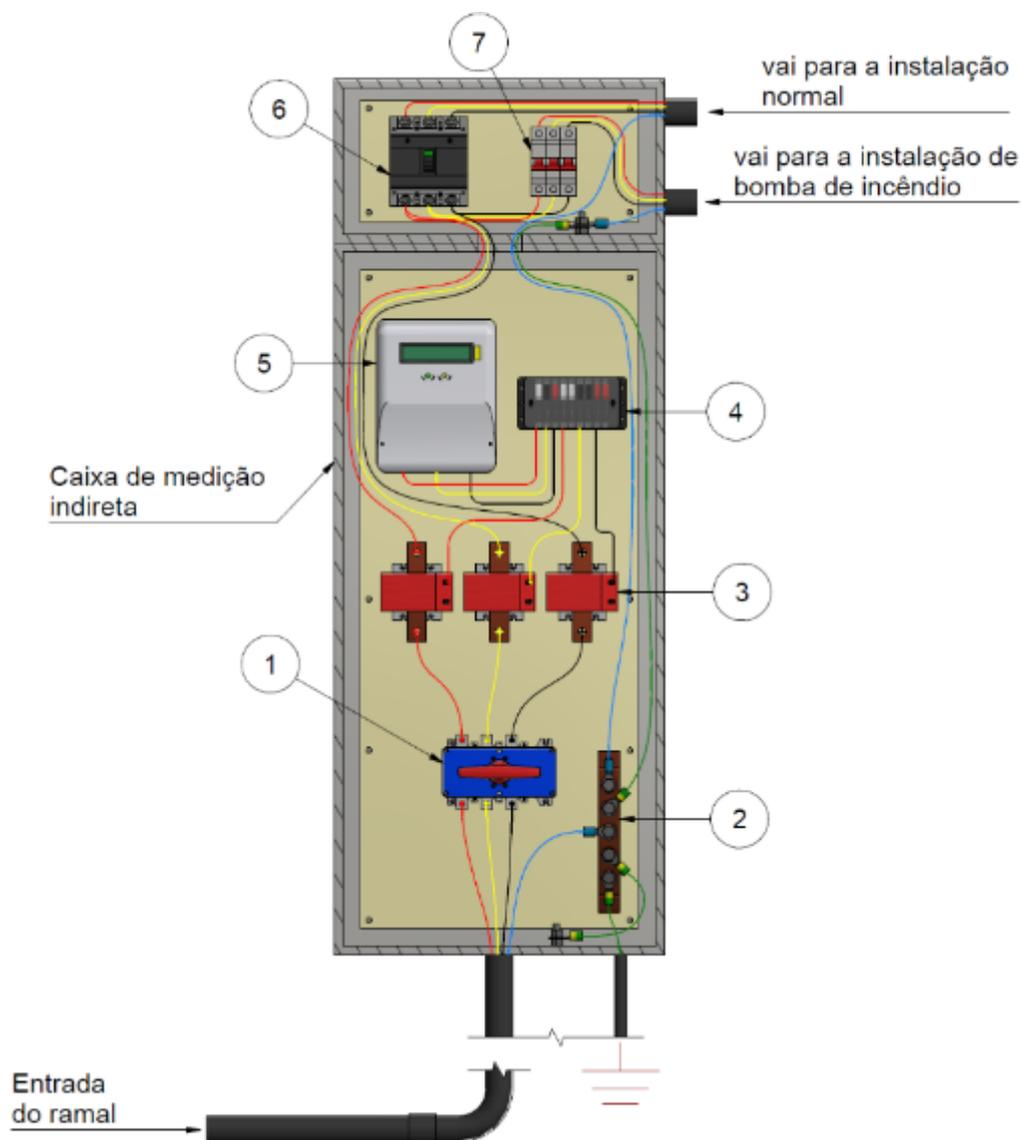
**Detalhe 2****b) Esquema de ligação instalação com bomba de incêndio**
