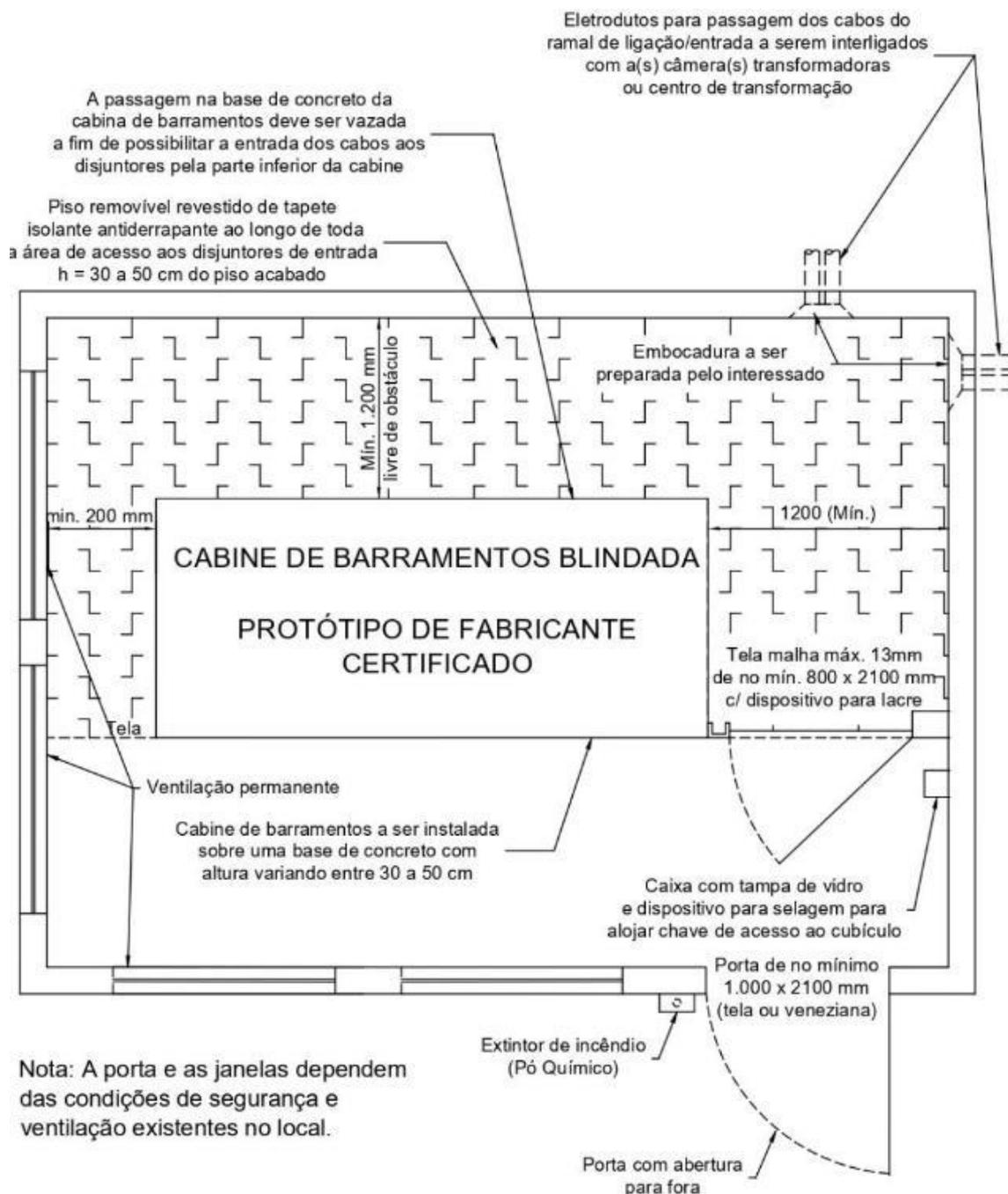
Figura 16 - Afastamentos mínimos necessários para a instalação de cabine de barramentos
