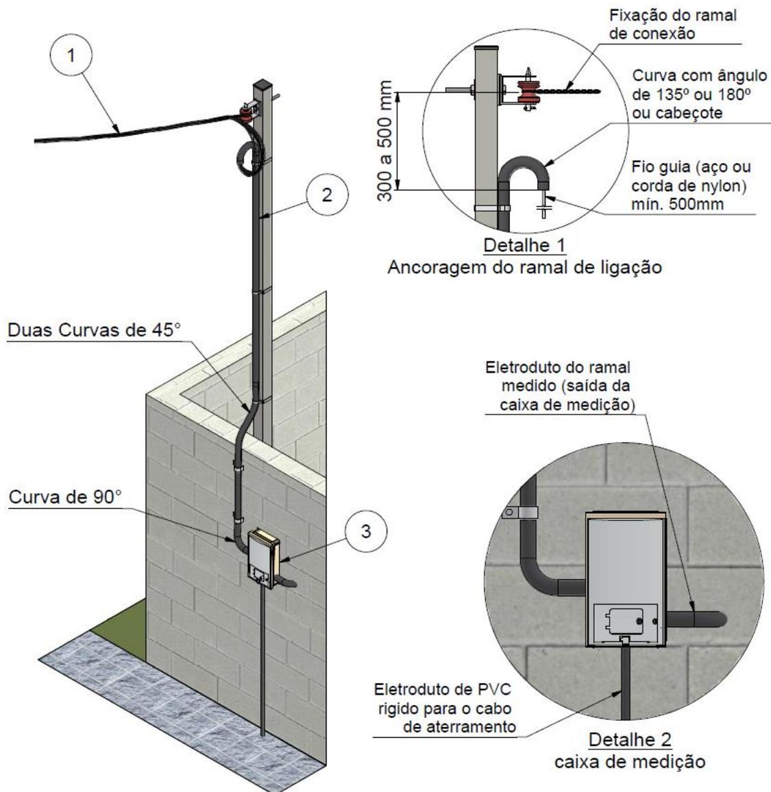
**Ponto de Conexão no medidor de kWh – Enel SP (continuação)**
