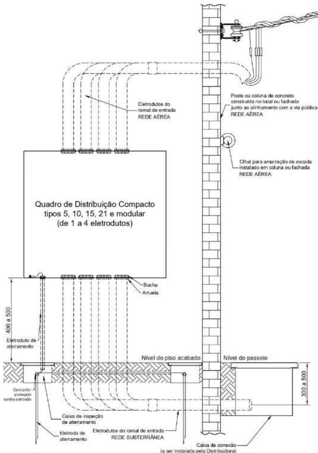
**Figura 10** - Quadro de Distribuição Compacto instalado ao nível da via pública de 1 a 4 eletrodutos - Entrada Inferior - Rede aérea ou subterrânea
