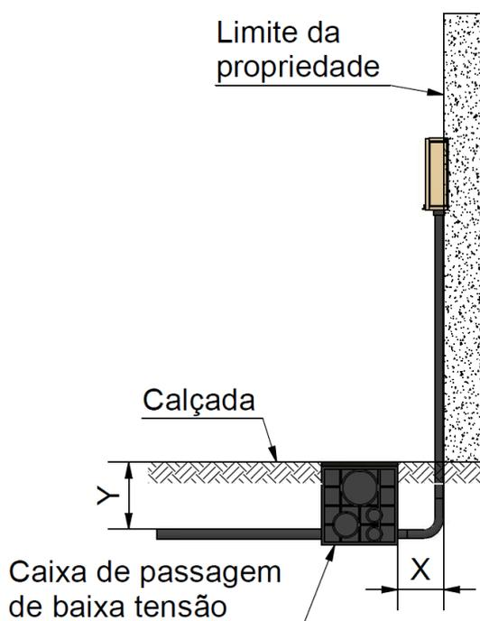
**Figura 5 - Instalação do Eletroduto do Ramal de conexão**
