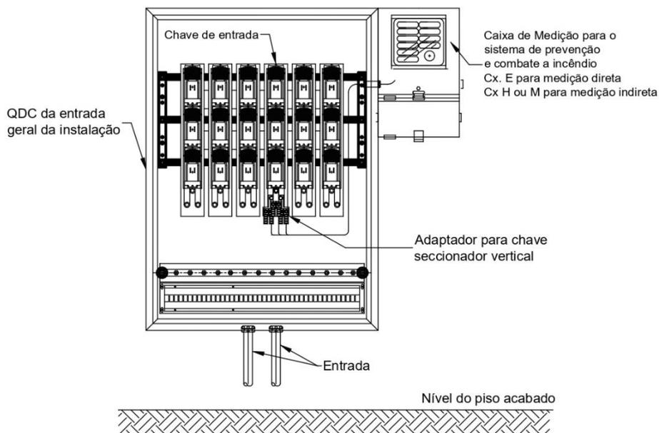
**LIGAÇÃO DE MEDIÇÃO PARA O SISTEMA DE PREVENÇÃO E COMBATE A INCÊNDIO**
