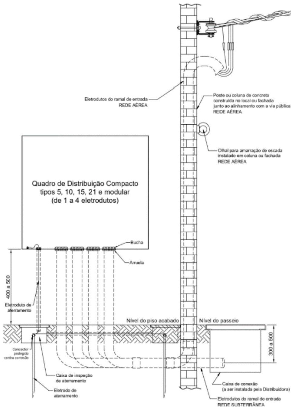
**Figura 11** - Quadro de Distribuição Compacto instalado ao nível da via pública de 1 a 4 eletrodutos - Entrada Inferior - Rede aérea ou subterrânea
