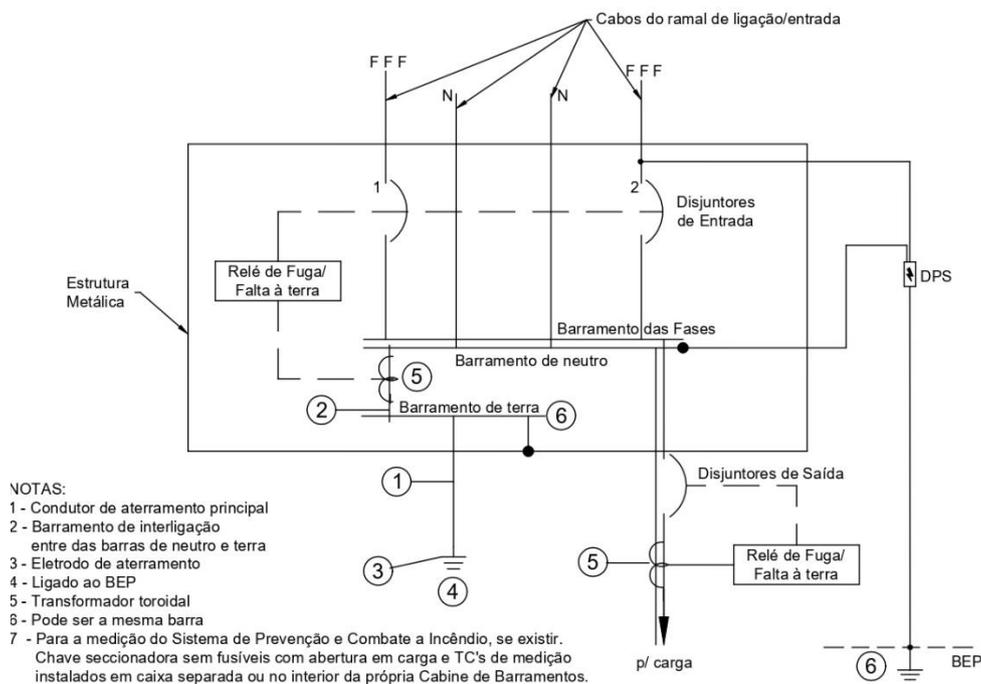
**Figura 20 - Diagrama unifilar básico para cabine de barramentos**
