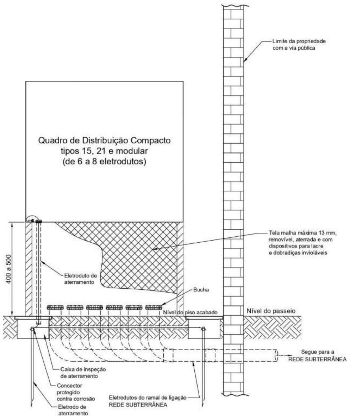
**Figura 13** - Quadro de Distribuição Compacto instalado ao nível da via pública de 6 a 8 eletrodutos - Rede subterrânea
