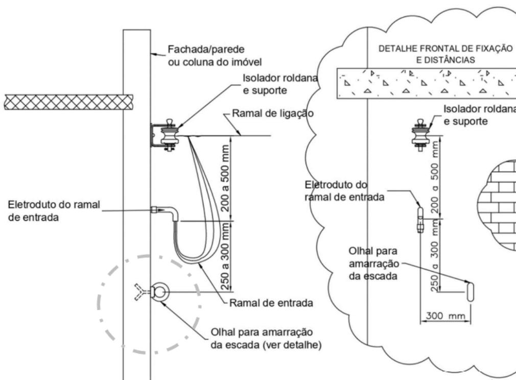
**b) Fio guia. (Ramal conexão até o medidor de kWh)**
